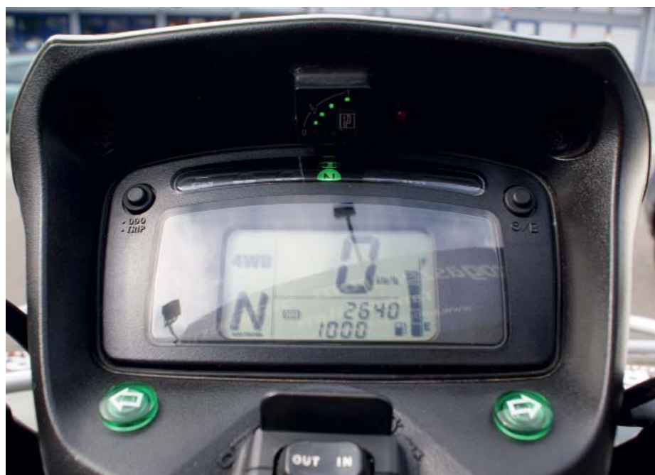
Füllstand: Die Tankanzeigen der Gasanlagen sind stets sehr minimalistisch gehalten.
