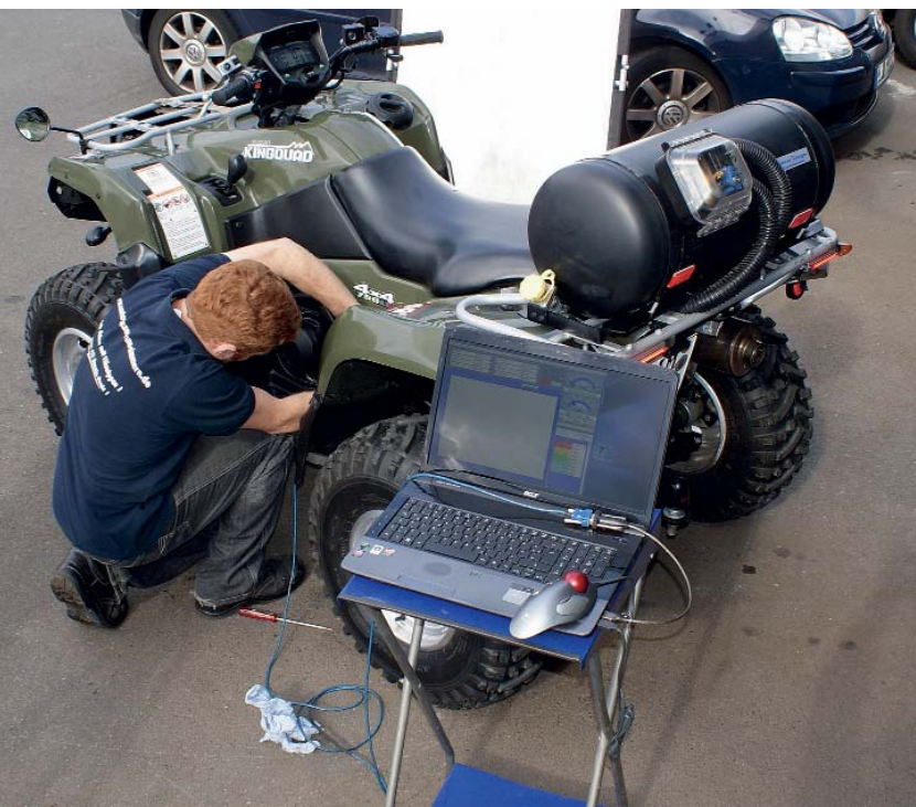
On Board Diagnose: Über einen Stecker lässt sich der Computer zu Einstellungszwecken anschließen.
