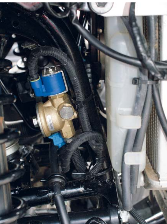
Mini-Bauteil: Der Verdampfer wurde speziell von Prins für die Verwendung am ATV konstruiert.
